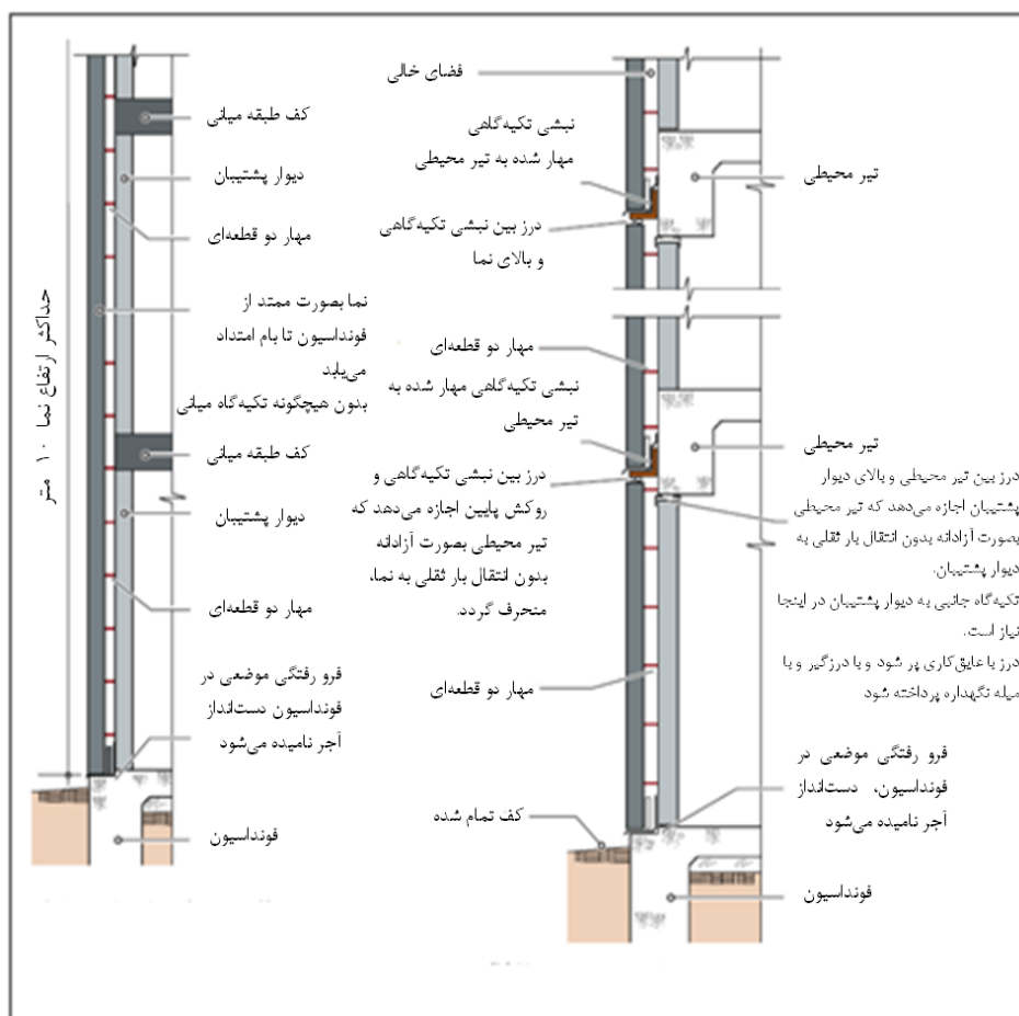
شکل ۵-۹ تکیه‌گاه‌ها جهت تحمل بار ثقیلی نما
