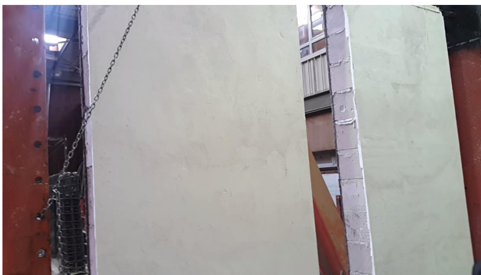
شکل (پ ۲-۸) نتیجه آزمون ضربه انجام شده بر روی دیوار AAC با یک لایه الیاف شیشه در دو طرف
