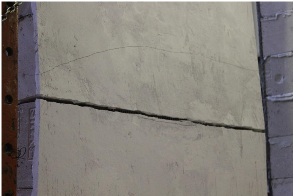
شکل (پ ۲-۹) بارگذاری خمشی پانل ( ۴ نقطه ای ) بر اساس استاندارد ملی ایران
