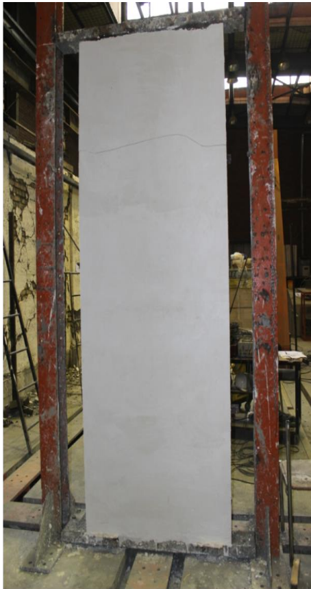
شکل (پ ۲-۳) بارگذاری خمشی پانل (۴ نقطه ای) بر اساس استاندارد ملی ایران
