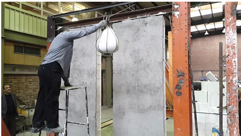
شکل (۳-۷) آزمایش ضربه جسم نرم سنگین
