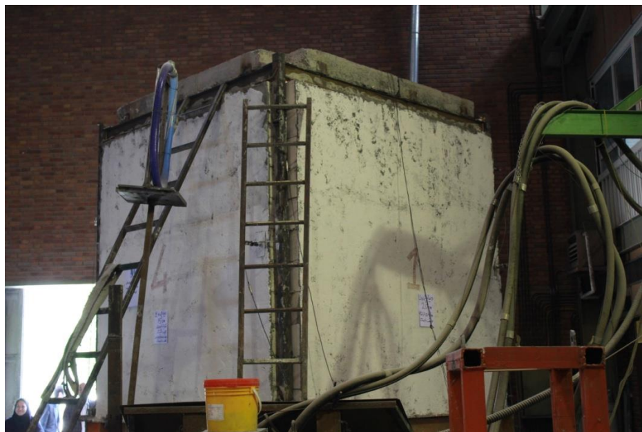
شکل (پ-۳) نمایی از ساختمان احداث شده بر روی میز لرزان
