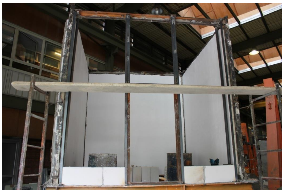
شکل (پ۱-۲۲) نمایی از ابزاربندی اجرای دیوار شماره (۳) در قاب
