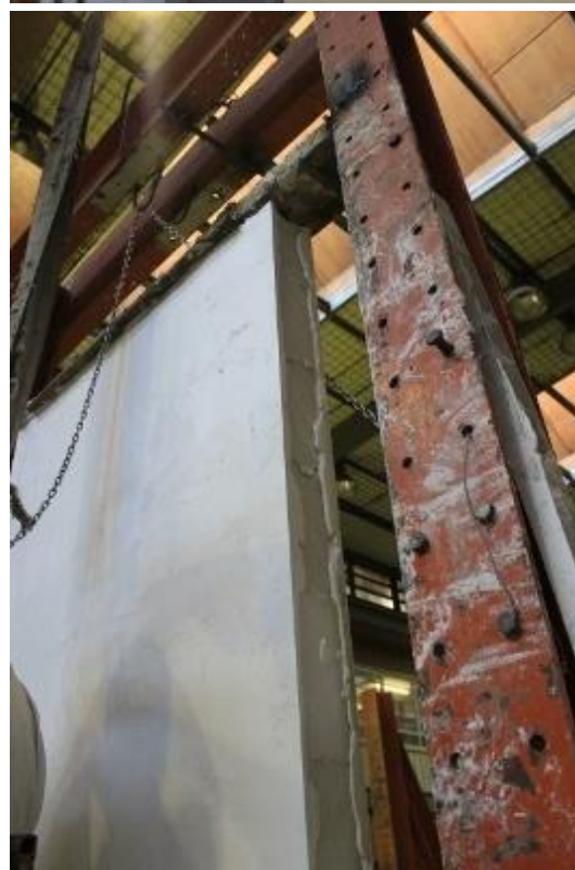
شکل (پ ۲-۱۹) نتیجه آزمون ضربه انجام شده بر روی دیوار AAC با ضخامت ۱۰ سانتی‌متر بدون لایه ایفای شیشه
