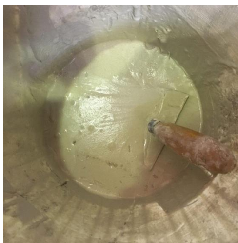
شکل (پ ۱-۵) ملات مخصوص اجرای تیغه‌های AAC
