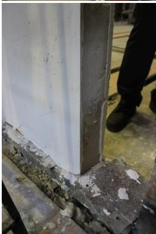
شکل (پ ۲-۱۹) نتیجه آزمون ضربه انجام شده بر روی دیوار AAC با ضخامت ۱۰ سانتی‌متر بدون لایه ایفای شیشه
