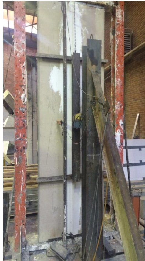
شکل (پ ۲-۳) بارگذاری خمشی پانل (۴ نقطه ای) بر اساس استاندارد ملی ایران
